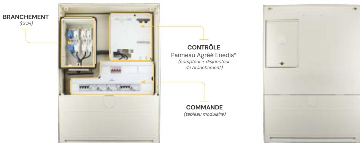
\* La séparation entre la norme NF C 14-100 du domaine public et la norme NF C 17-200 du domaine privé est assurée par l'intermédiaire d'un panneau agréé Enedis. Une séparation par une porte ou un compartiment différencié n'est pas nécessaire dans ce cas entre les fonctions Contrôle et Commande.
